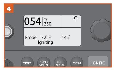
Nach Einstellen des Temperaturfühleralarms zeigt der Startbildschirm die Gartemperatur, die Solltemperatur des Temperaturfühlers und den Status des Grills an. Wenn Ihr Fleisch die eingestellte Alarmtemperatur erreicht hat, ertönt der Alarm. Bei Verwendung der Traeger-WiFIRE-App wird während des gesamten Grillvorgangs eine Push-Mitteilung zusammen mit dem Status Ihres Grills auf Ihr angeschlossenes Smart-Gerät ausgegeben.
