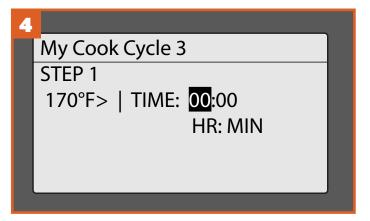
Wenn das Rezept eine bestimmte Zeit bei einer eingestellten Temperatur vorgibt, wählen Sie TIME (Zeit) aus. Drehen Sie den Drehknopf, um die Stunden einzustellen. Drücken Sie, um die Einstellung zu übernehmen und zur Minuteneinstellung zu gelangen. Drehen Sie den Drehknopf, um die Minuten einzustellen und drücken Sie den Drehknopf, um die Einstellung abzuschließen.
