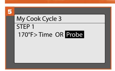
Wenn das Rezept eine bestimmte Kerntemperatur für das Fleisch vorgibt, wählen Sie "Probe" (Temperaturfühler) aus. Wählen Sie mit dem Auswahldrehknopf die gewünschte Solltemperatur.
