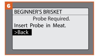
Wenn der Temperaturfühler benötigt wird, werden Sie angewiesen, den Temperaturfühler in das Fleisch einzuführen. Stecken Sie dann den Temperaturfühler in die Anschlussbuchse am Controller ein. Sobald der Temperaturfühler erkannt wird, ertönt ein Ton. Um den Garzyklus sofort auszuführen, wählen Sie RUN COOK CYCLE NOW (Garzyklus jetzt ausführen) und wählen Sie bei der Bestätigungsabfrage "YES" (Ja).
