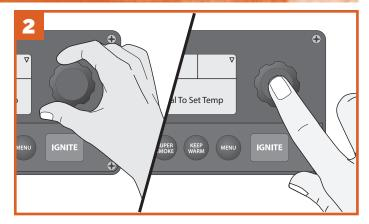
Um die Temperatur zu wählen, drehen Sie den Auswahldrehknopf nach rechts oder links. Wenn die gewünschte Temperatur angezeigt wird, drücken Sie auf die Mitte des Drehknopfs, um die Einstellung zu übernehmen.
