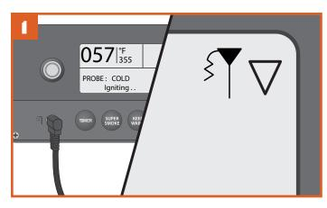
Stecken Sie den Temperaturfühler in die Anschlussbuchse am WiFIRE-Controller ein. Zum Einschalten des Grills siehe "Bedienung des Grills". Wenn der Grill eingeschaltet ist, erkennt der Controller den Temperaturfühler und das Temperaturfühlersymbol leuchtet in der rechten oberen Ecke des Controller-Bildschirms.
