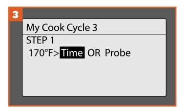
Nachdem Sie die Temperatur eingestellt haben, wählen Sie entweder Time (Zeit) (für eine festgelegte Gardauer) oder Probe (Temperaturfühler) (zum Garen, bis die eingestellte Kerntemperatur erreicht ist).
