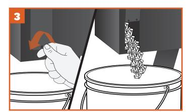
Schrauben Sie den Riegel von der Entleerungsklappe ab, um diese zu öffnen. Die Pellets fallen dann in den Behälter unter der Klappe. Mit einem Spatel oder einem Löffel können Sie die restlichen Pellets aus der Pelletkammer entfernen.
