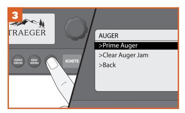
Drücken Sie die Wartemodus-Taste, um den Wartemodus zu verlassen. Drücken Sie "MENU" (Menü), um das Hauptmenü anzuzeigen. Drehen Sie Drehknopf drehen, um "AUGER" (Förderschnecke) zu wählen, und dann "Prime Auger" (Förderschnecke vorfüllen).
