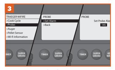
Drücken Sie auf MENU (Menü), blättern Sie zu PROBE (Temperaturfühler) und wählen Sie die Option aus. Sie werden dazu aufgefordert, einen Temperaturfühleralarm für die Kernsolltemperatur einzustellen. Wählen Sie SET ALARM (Alarm einstellen) aus. Wählen Sie anschließend im Menü "Probe" (Temperaturfühler) mit dem Auswahldrehknopf die Solltemperatur für Ihr Fleisch aus.
