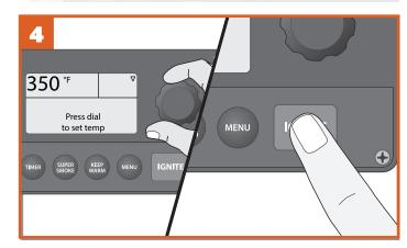
Auf dem Startbildschirm wird "Press dial to set temp" (Drehknopf drücken, um Temperatur einzustellen) angezeigt. Drehen Sie den Auswahldrehknopf im Uhrzeigersinn auf 177 °C und drücken Sie den Drehknopf. Drücken Sie anschließend "IGNITE" (Zünden), schließen Sie den Deckel und lassen Sie den Grill nach Erreichen der eingestellten Temperatur 20 Minuten lang aufheizen.
