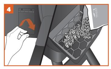
Nach Entleerung der Pelletkammer schließen Sie die Klappe und verschrauben den Riegel. Nun können Sie die Pelletkammer mit einer neuen Sorte TRAEGER HARTHOLZPELLETS befüllen.
