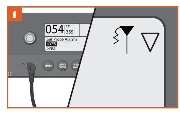
Stecken Sie den Temperaturfühler in die Anschlussbuchse am WiFIRE-Controller ein. Der Controller erkennt den Temperaturfühler und das Temperaturfühlersymbol leuchtet in der rechten oberen Ecke des Controller-Bildschirms. Auf dem Display wird eine Frage angezeigt, ob Sie einen Alarm einstellen möchten. Wählen Sie hier "YES" (Ja).
