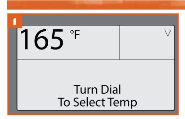
Nach Betätigung der Wartemodus-Taste kehrt der Grill als Standard zur Anzeige "Turn Dial To Select Temp" (Drehknopf drehen, um Temperatur auszuwählen) zurück. Die Gartemperatur kann direkt in diesem Bildschirm gewählt werden.
