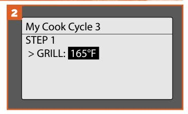
In Step I (Schritt I) wird eine Aufforderung angezeigt, die Grilltemperatur einzustellen (die Standardeinstellung ist 74 °C). Stellen Sie mit dem Auswahldrehknopf die gewünschte Temperatur ein und drücken Sie zur Auswahl auf die Mitte des Drehknopfs.
